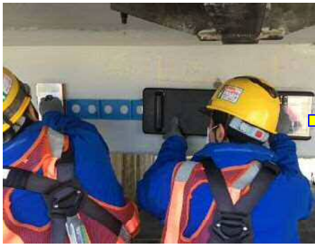
磁石と計測器を用いて測定
